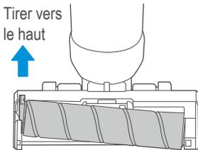
**2** Retirer la brosse à rouleau, ouvrir la lame rotative de la brosse de nettoyage et enlever les cheveux et autres enchevêtrements sur la brosse à rouleau.
